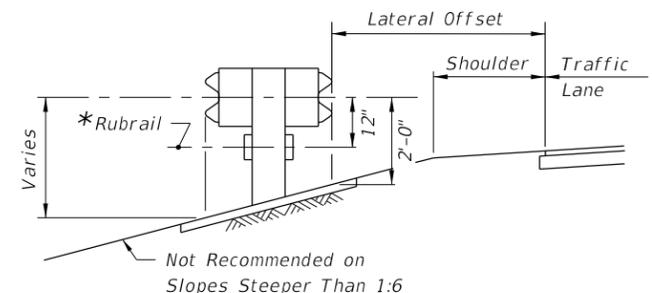
**GUARDRAIL ON MEDIAN SLOPES**
