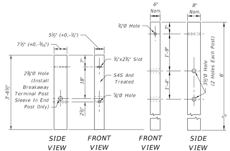
**SPECIAL TIMBER GUARDRAIL POSTS**
