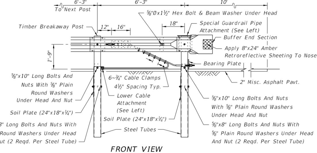
**GUARDRAIL END ANCHORAGE ASSEMBLY TYPE CRT**
